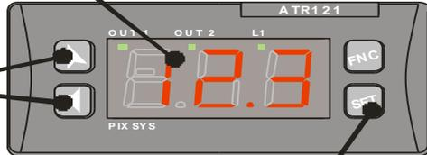
Schaltpunkte anzeigen (z.B. eingestellte Temperatur), Einmal druecken fuer Set1 (Led Out1 blinkt), zweimal druecken fuer Set2 (Led Out2 blinkt). Im Konfiguration-Modus zusammen mit Pfeiltasten druecken zur Aenderung des angezeigten Parameters
